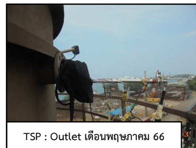
ภาพที่ 3.6 การตรวจวัดคุณภาพอากาศจากปล่อง Baghouse
