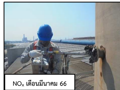
ภาพที่ 3.6 การตรวจวัดคุณภาพอากาศจากปล่อง Baghouse
