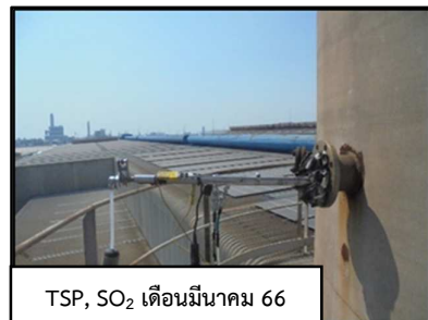
ภาพที่ 3.6 การตรวจวัดคุณภาพอากาศจากปล่อง Baghouse
